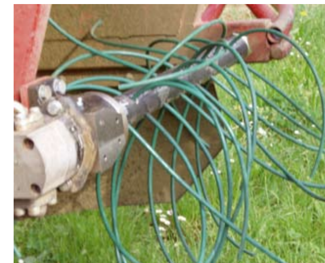
Rotore con tondino di poliuretano - Rotor with polyurethane rod
